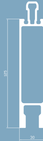
Hochwasserschutzprofil 30 mm H= 125 mm, ca. 3,11 kg/lfm
