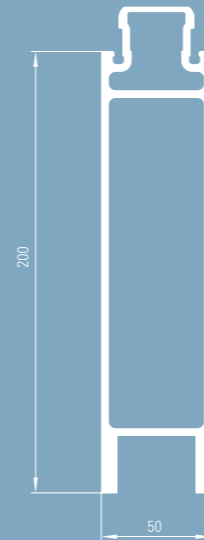
Hochwasserschutzprofil 50 mm H= 200 mm, ca. 6,25 kg/lfm
