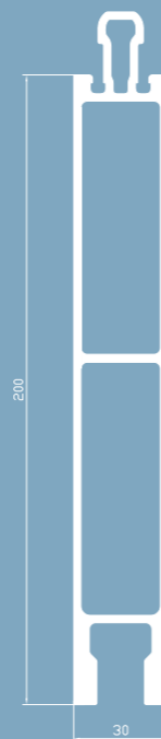
Hochwasserschutzprofil 30 mm H= 200 mm, ca. 4,20 kg/lfm
